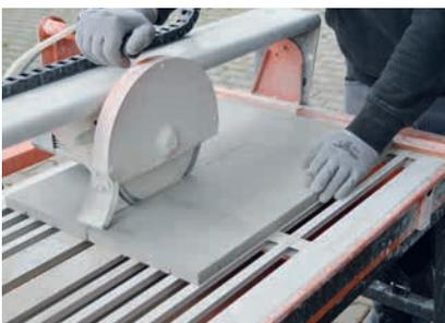
Zuschchnitt der Elemente mit einer herkömmlichen Diamanttrennscheibe ohne Wassereinsatz.
