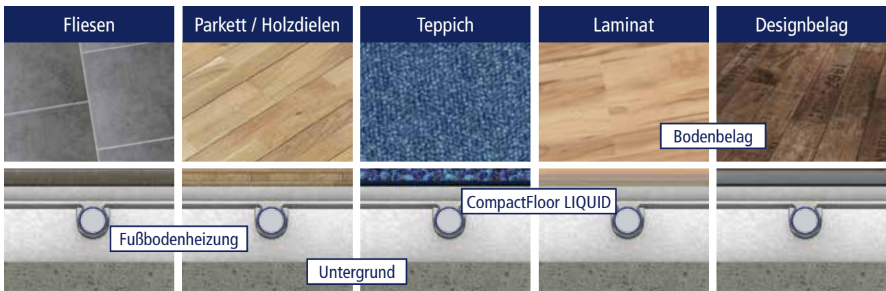
Schichtaufbau: Trockenbau-Fußbodenheizung, CompactFloor LIQUID Kontaktschicht, CompactFloor LIQUID Tragschicht, Bodenbelag
