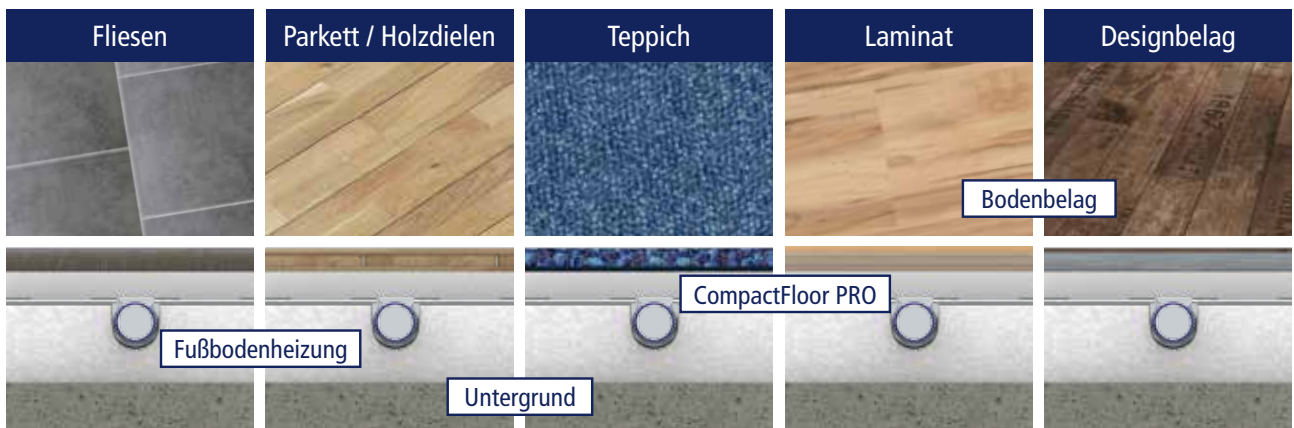
Schichtaufbau: Trockenbau-Fußbodenheizung, CompactFloor PRO, Bodenbelag
