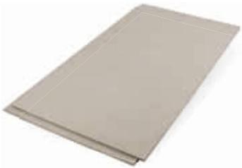
Die Faserzementplatte CompactFloor® PRO 12 ist eine schwimmend zu verlegende Wärmeleitschicht für Fußbodenheizungen im Trockenbau. Die flachen Platten sind für nahezu jeden Bodenbelag geeignet und machen die Fußbodenheizung zu einem reaktionsschnellen Heizsystem. Niedriger Aufbau, geringe Trägheit, hohe Wärmeleistung und die Eignung für jeden Bodenbelag – die Vorteile einer Fußbodenheizung mit CompactFloor® PRO 12.
