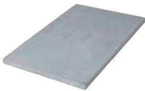
CompactFloor EXPERT ist mit einer Belastbarkeit von 5,0 kN/m<sup>2</sup> in Wohnungs-, Büro- und Gewerbebauten gleichermaßen einsetzbar. Die 20 mm starken faserverstärkten Betonelemente leiten die Wärme direkt an den Bodenbelag weiter. Durch die trockene Verlegung der Elemente wird die Bauzeit stark verkürzt.
